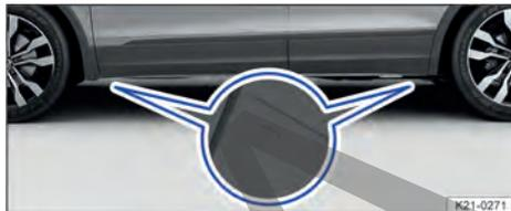
**Fig. 260** Puntos de apoyo para el gato (representación esquemática).
