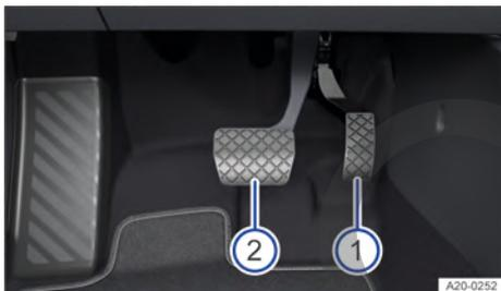
Fig. 122 En la zona reposapiés: pedales en los vehículos con cambio automático.
