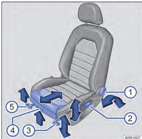
**Fig. 81** En el asiento del conductor: mandos (variante 2).
