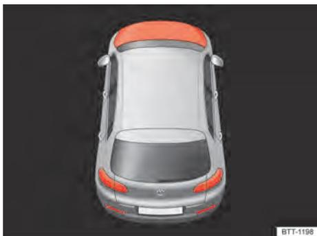
**Fig. 236** En la pantalla del cuadro de instrumentos: capó delantero abierto o no cerrado correctamente (representación esquemática).
