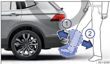
Fig. 73 Portón del maletero con apertura controlada por sensor (Easy Open).
