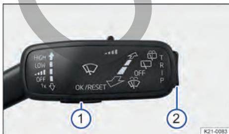
**Fig. 17** En el lado derecho de la columna de dirección: teclas de la palanca del limpiacristales.
