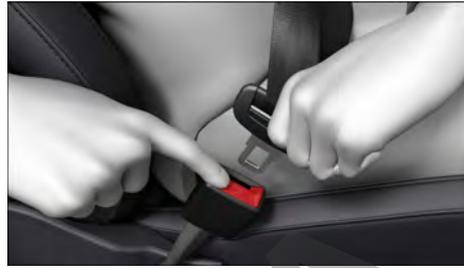
**Fig. 31** Soltar la lengüeta del cierre del cinturón.
