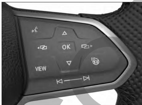
**Fig. 16** Lado derecho del volante multifunción: teclas para utilizar los menús y las indicaciones informativas del cuadro de instrumentos (variante 2).
