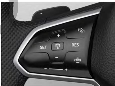
Fig. 145 Lado izquierdo del volante multifunción (variante 2).
