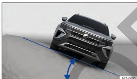
**Fig. 139** Representación esquemática: ángulo de inclinación.
