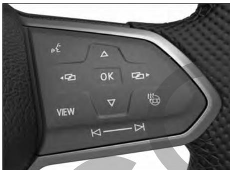
**Fig. 12** Lado derecho del volante multifunción: teclas para utilizar los menús y las indicaciones informativas del cuadro de instrumentos (variante 2).
