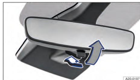
Fig. 113 En el parabrisas: retrovisor interior antideslumbrante manual.
