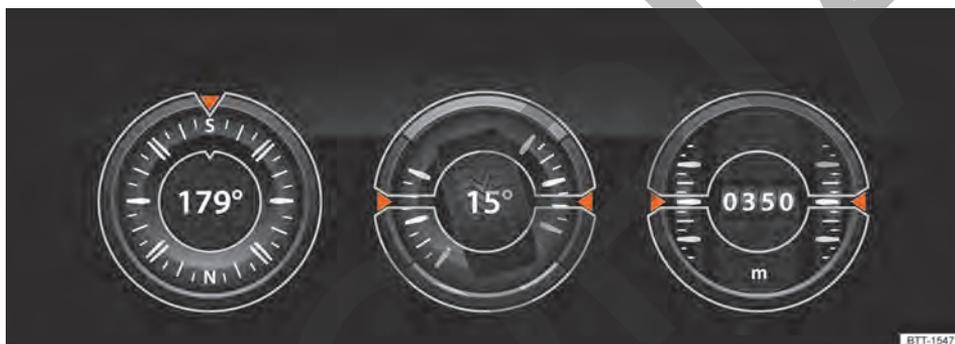
Fig. 137 En el sistema de infotainment: indicador Offroad.
