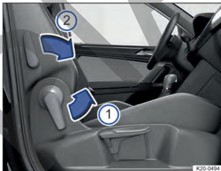
**Fig. 85** Asiento del acompañante: abatir el respaldo hacia delante.
