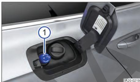
Fig. 208 Detrás de la tapa del depósito de combustible: tapón del depósito de AdBlue (representación esquemática).
