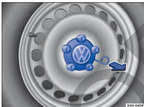
Fig. 252 Desmontar el tapacubos central tirando de él.
