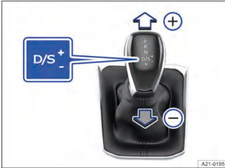
**Fig. 132** Palanca selectora en la posición Tiptronic.
