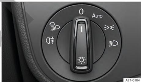
**Fig. 104** Junto al volante: mando de las luces (una variante).
