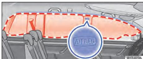
Fig. 43 En el lado izquierdo del vehículo (7 plazas): ubicación y zona de despliegue del airbag para la cabeza.
