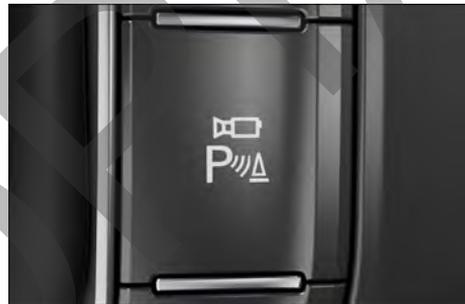
**Fig. 170** En la consola central: tecla para conectar y desconectar el sistema de visión periférica.
