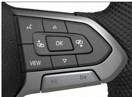
**Fig. 15** Lado derecho del volante multifunción: teclas para utilizar los menús y las indicaciones informativas del cuadro de instrumentos (variante 1).
