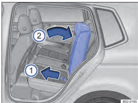
Fig. 87 Ajuste del respaldo del asiento trasero.
