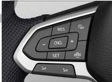
Fig. 142 Lado izquierdo del volante multifunción (veriente 1).
