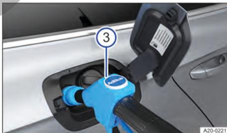
Fig. 210 Detrás de la tapa del depósito de combustible: repostar AdBlue con la pistola de un surtidor (representación esquemática).
