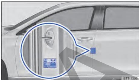
Fig. 249 En el pilar de la puerta del conductor: adhesivo de la presión de los neumáticos (o en la cara interior de la tapa del depósito de combustible).
