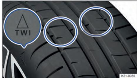
Fig. 250 Perfil del neumático: indicadores de desgaste.
