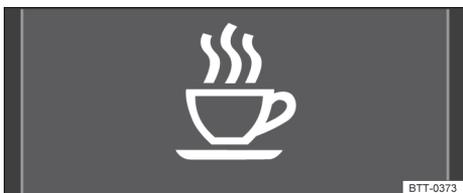
**Fig. 24** En la pantalla del cuadro de instrumentos: símbolo de detección del cansancio.
