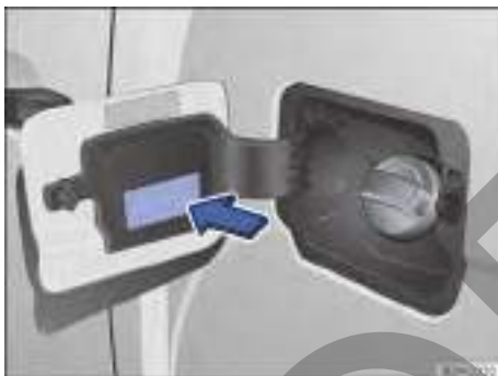
Fig. 132 En la tapa del depósito de combustible: adhesivo del combustible.
