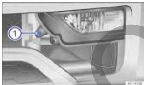
Fig. 148 En el paragolpes delantero: desmontar el faro.
