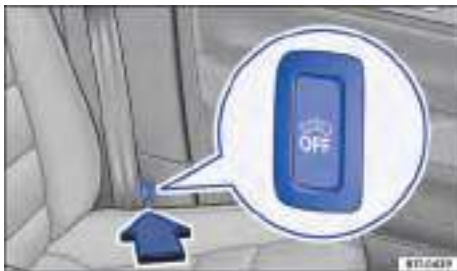
Fig. 49 Junto al asiento del conductor: tecla para desconectar la vigilancia del habitáculo y el sistema antirremolcado.
