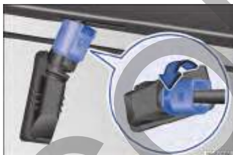
Fig. 156 Luz de matrícula: desmontaje del portalámparas.
