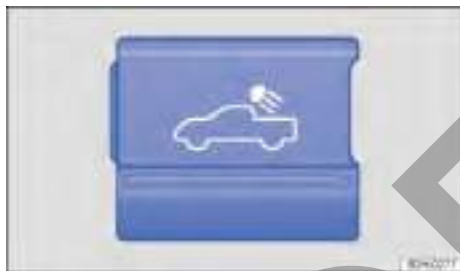
Fig. 76 En la consola central: tecla de la luz de la superficie de carga.
