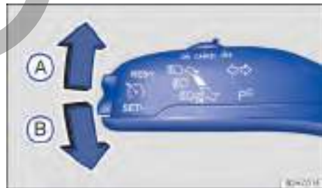
Fig. 73 En el lado izquierdo de la columna de dirección: palanca de los intermitentes y de la luz de carretera.
