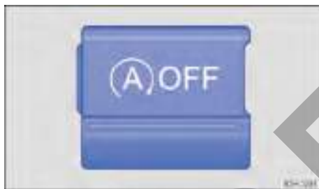
Fig. 91 En la consola central: tecla del sistema Start-Stop.
