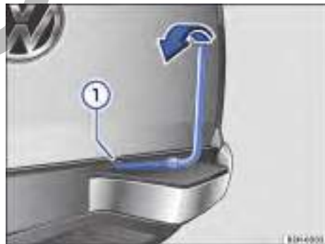
Fig. 202 Subir la rueda de repuesto mediante el ca-brestante.
