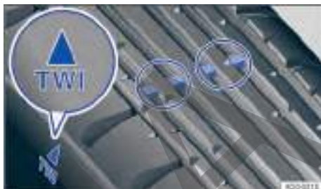
Fig. 189 Perfil del neumático: indicadores de desgaste.
