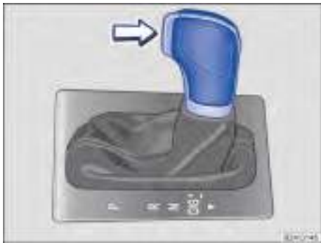
Fig. 93 Vehículos con el volante a la izquierda: palanca selectora del cambio automático con tecla de bloqueo (flecha). En los vehículos con el volante a la derecha, la disposición es simétrica.
