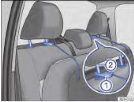
Fig. 60 En el asiento trasero: fijación de la banqueta en los apoyacabezas.
