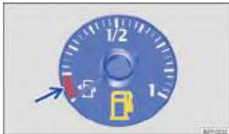
Fig. 14 Indicador del nivel de combustible en el cuadro de instrumentos analógico (representación esquemática).
