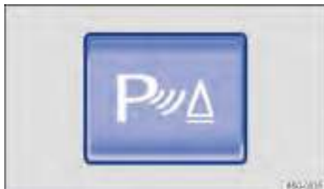
Fig. 109 En la consola central: tecla para conectar y desconectar la ayuda de aparcamiento (en función del equipamiento).
