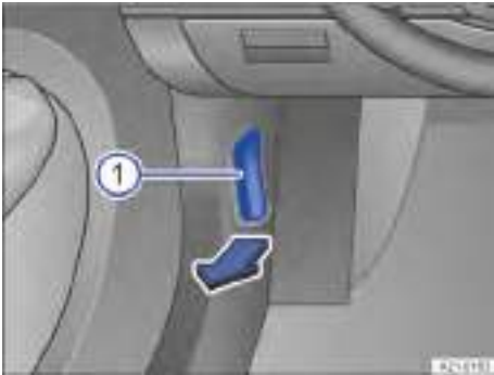
Fig. 170 En la zona reposapiés izquierda: palanca de desbloqueo del capó delantero (representación esquemática).
