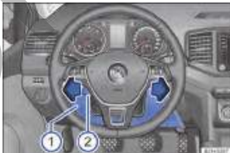
Fig. 160 En el lado del conductor, vehículos con el volante a la izquierda: caja de fusibles detrás del guanrecido del tablero de instrumentos.
