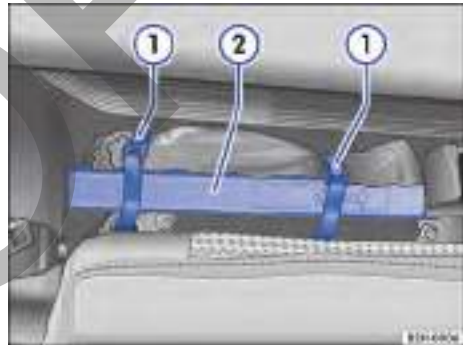
Fig. 44 Detrás del respaldo de la plaza trasera derecha: triángulo de preseñalización ②.
