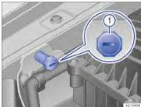
Fig. 163 En el lado derecho del vano motor: toma para la ayuda de arranque (terminal de masa).
