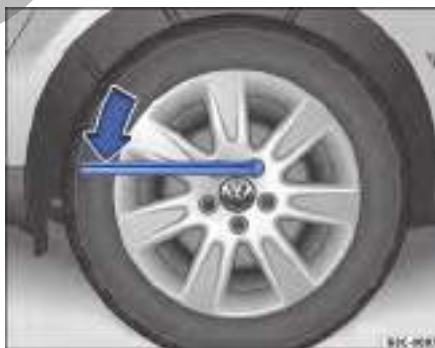
Fig. 193 Cambio de una rueda: aflojar los tornillos.
