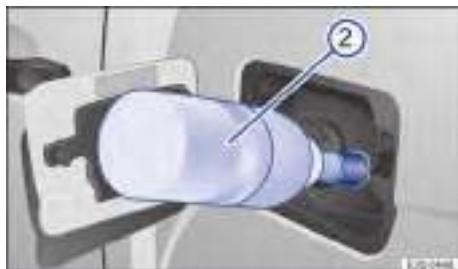
Fig. 136 Cargar AdBlue con una botella de recarga.
