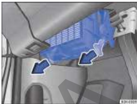
Fig. 159 Caja de fusibles debajo del tablero de instrumentos.
