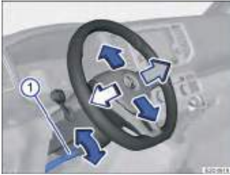
Fig. 54 Debajo del volante, en el guarnecido de la columna de dirección: palanca para el ajuste manual de la posición del volante.
