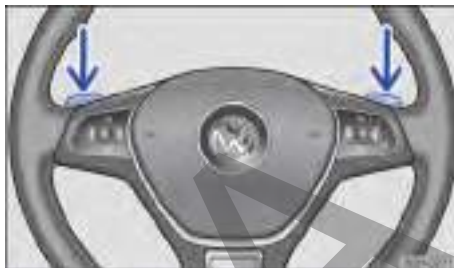
Fig. 95 Volante con levas de cambios para el Tiptronic.
