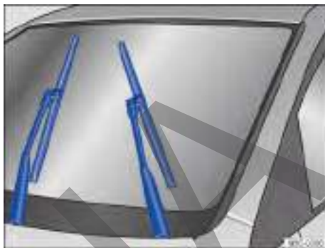
Fig. 141 En el parabrisas: limpiaparabrisas en posición de servicio (representación esquemática).
