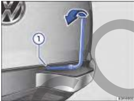
Fig. 196 Controlar el cable elevador con el cabrestante.
