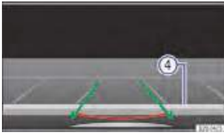
Fig. 112 Visualización en la pantalla del sistema de infotainment: centrar el vehículo en el hueco de aparcamiento.
