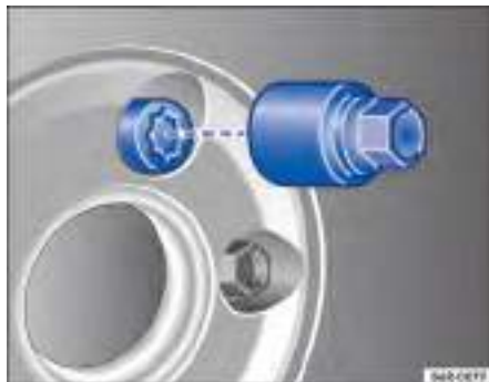
Fig. 194 Cambiar una rueda: tornillo de rueda antirrobo y adaptador.
