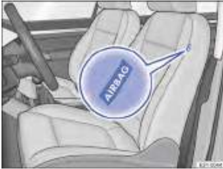
Fig. 34 Lateral de un asiento delantero: ubicación del airbag lateral para la cabeza y el tórax (variante 2).
