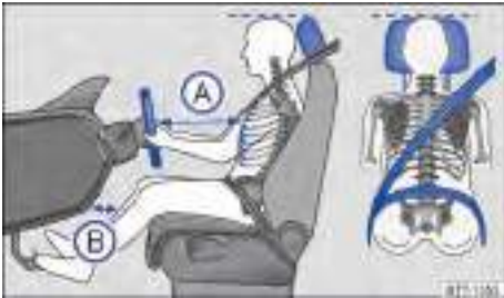
Fig. 17 Representación esquemática: distancia correcta entre el conductor y el volante, colocación correcta de la banda del cinturón y ajuste correcto del apoyacabezas.
