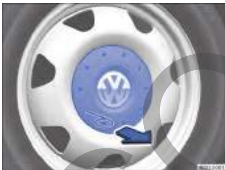
Fig. 191 Desmontar el tapacubos central tirando de él.
