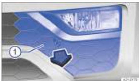
Fig. 147 En el paragolpes delantero: desmontar la cubierta.
