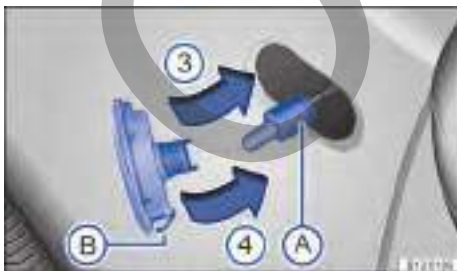
Fig. 154 Intermitente lateral: cambiar la lámpara.
