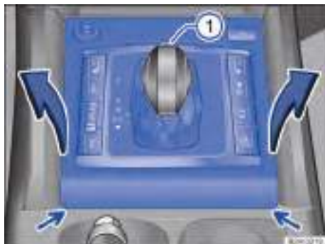
Fig. 96 Desmontar la cubierta de la corredera de la palanca selectora.
