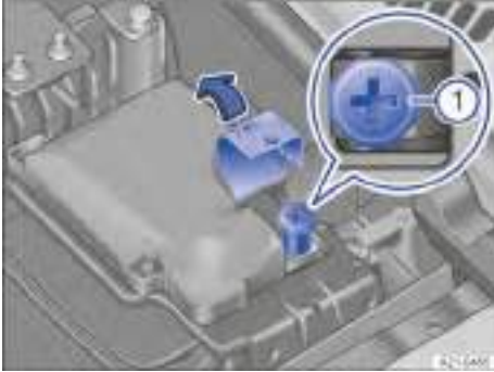
Fig. 164 En el lado izquierdo del vano motor, debajo de una cubierta: toma para la ayuda de arranque (polo positivo).
