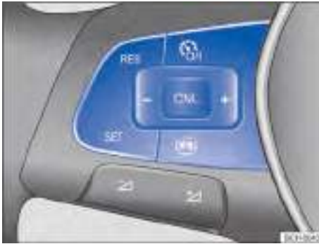
Fig. 95 Lado izquierdo del volante multifunción (variante 1): teclas para controlar el GRA
