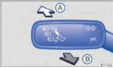
Fig. 71 A la izquierda en la columna de dirección: palanca de los indicadores de dirección y del farol alto.
