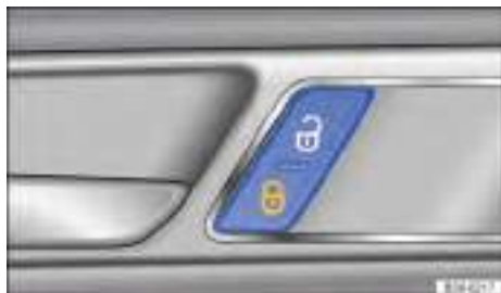
Fig. 51 En la puerta del conductor: tecla del cierre centralizado.
