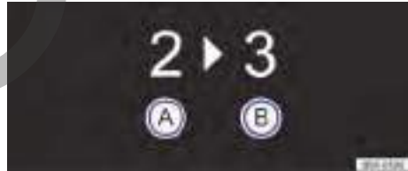
Fig. 84 En el instrumento combinado: indicador de cambio de marcha.
