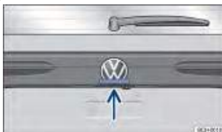
Fig. 57 En la tapa trasera: botón para abrir la tapa trasera.
