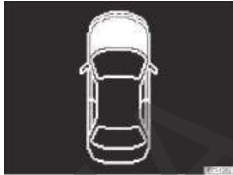
Fig. 181 En el display del instrumento combinado: tapa del compartimento del motor abierta o cerrada incorrectamente (representación esquemática).
