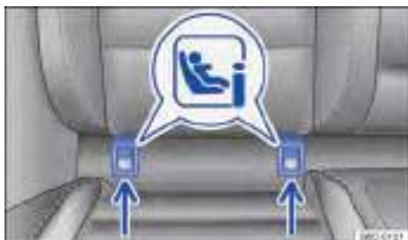
Fig. 41 En el asiento del vehículo: identificación de los puntos de anclaje inferiores de asientos para niños.
