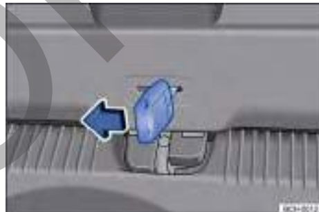
Fig. 59 En el maletero: desbloquear la tapa trasera.
