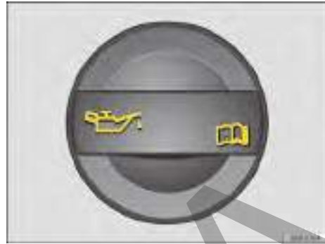
Fig. 184 En el compartimento del motor: tapón de la boca de llenado del aceite del motor.
