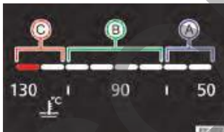
Fig. 14 Indicador de temperatura del líquido refrigerante del motor en el instrumento combinado digital (variante 2): (A) zona fría; (B) zona normal; (C) zona de alerta.
