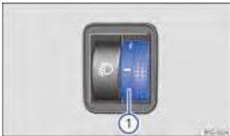
Fig. 72 Al lado del volante: ajustador de alcance de faros ①
