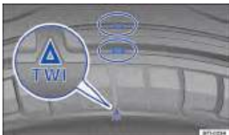
Fig. 193 Perfil del neumático: indicadores de desgaste.
