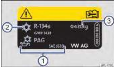
Fig. 205 Información del aire acondicionado
