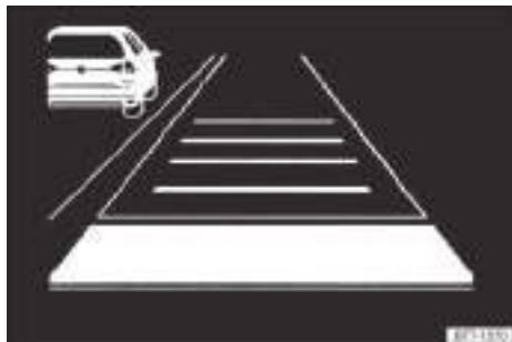
Fig. 99 En el display del instrumento combinado: vehículo más lento detectado en el carril izquierdo (representación esquemática).
