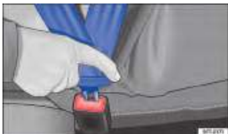
Fig. 27 Introducir la pestaña de encastre del cinturón de seguridad en el cierre del cinturón.
