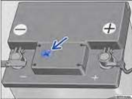
Fig. 188 En el compartimento del motor: ejemplo de posición del visor en el lado superior de la batería del vehículo.
