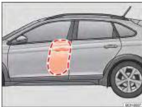
Fig. 36 Del lado izquierdo del vehículo: áreas de expansión del airbag lateral.
