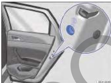
Fig. 44 En la puerta trasera (lado derecho): ubicación del seguro para niños.
