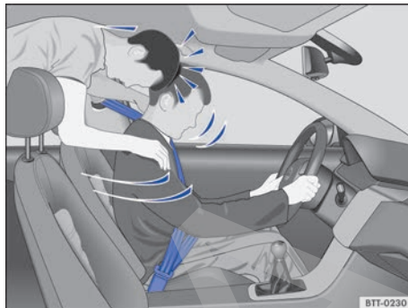
Fig. 46 El ocupante del asiento trasero sin el cinturón de seguridad colocado sale lanzado hacia delante topando contra el conductor, que sí lo lleva colocado.
