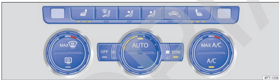
Fig. 136 En la parte superior de la consola central: mandos del Climatronic.
