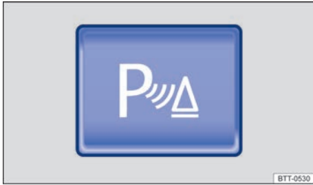
Fig. 114 En la consola central: tecla para conectar y desconectar el ParkPilot.
