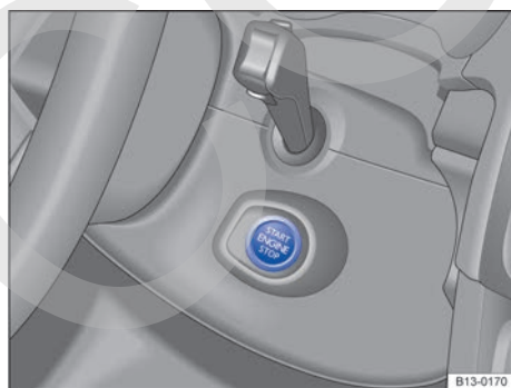
Fig. 100 Sistema de cierre y arranque Keyless Access: pulsador de arranque.
