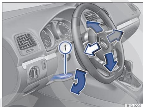
Fig. 37 Debajo del volante, en el garnecido de la columna de dirección: palanca para el ajuste manual de la posición del volante.
