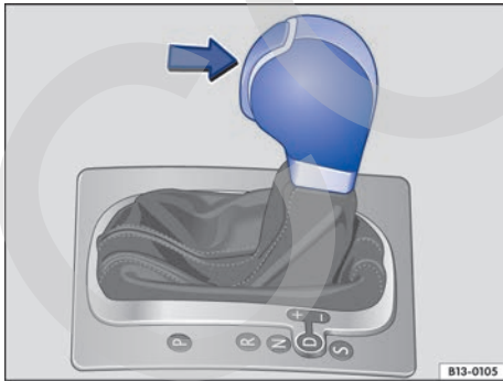
Fig. 105 Vehículo con el volante a la izquierda: palanca selectora del cambio automático con tecla de bloqueo (flecha). En los vehículos con el volante a la derecha, la disposición es simétrica. ▶
