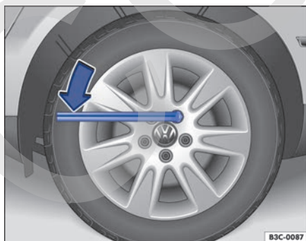
Fig. 179 Cambio de rueda: aflojar los tornillos de rueda.
