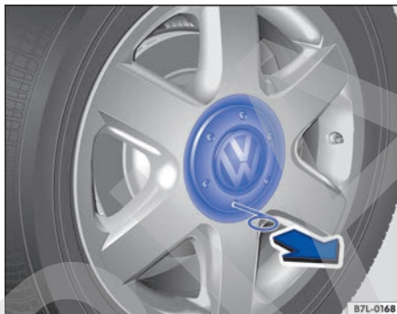
Fig. 175 Desmontar el tapacubos central.
