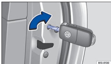
Fig. 167 En el frontal de la puerta del acompañante: bloqueo de emergencia de la puerta del acompañante con la llave del vehículo.
