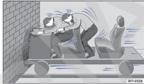
Fig. 44 El vehículo choca contra el muro. Los ocupantes no llevan colocado el cinturón de seguridad.
