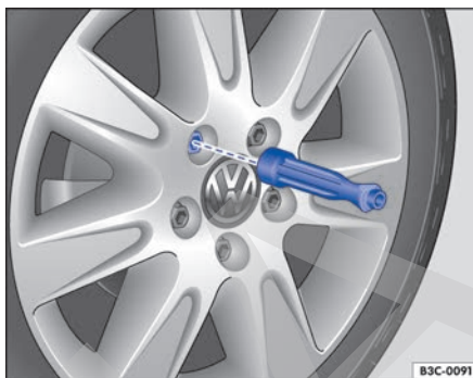
Fig. 185 Cambio de rueda: desenrosca los tornillos de rueda con el mango del destornillador.
