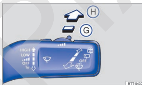
Fig. 72 En el lado derecho de la columna de dirección: manejo del limpiacristales.
