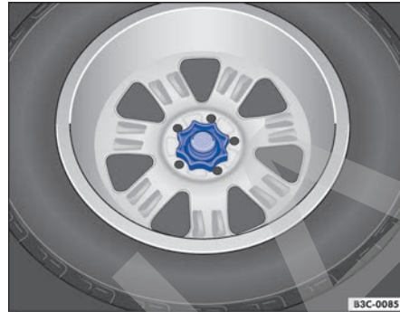
Fig. 156 En el maletero: ruedecilla para fijación de la rueda de repuesto.
