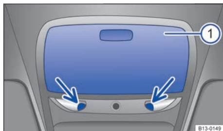
Fig. 23 En la consola del techo: sensores de la vigilancia del habitáculo junto al portaobjetos.
