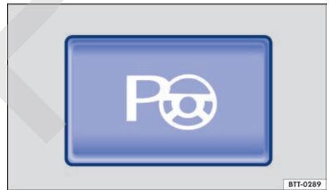
Fig. 122 En la parte inferior de la consola central: tecla para conectar el sistema de aparcamiento asistido.
