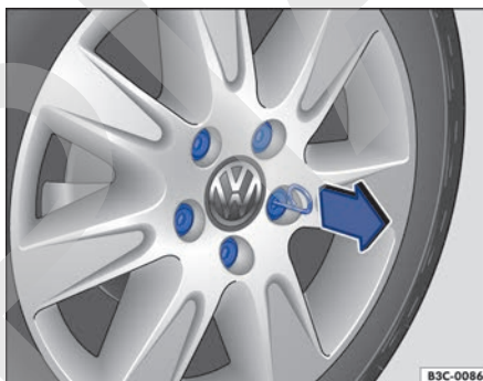
Fig. 178 Quitar los capuchones de los tornillos de rueda.
