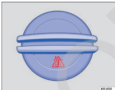
Fig. 148 En el vano motor: tapa del depósito de expansión del líquido refrigerante del motor.
