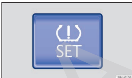
Fig. 151 En la guantera: tecla del sistema de control de los neumáticos.
