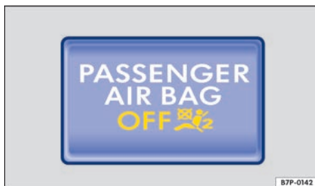
Fig. 52 En la parte superior de la consola central: testigo de control de la desactivación del airbag frontal del acompañante.
