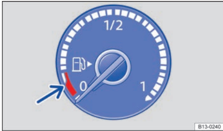
Fig. 139 En el cuadro de instrumentos: indicador del nivel de gasolina o gasóleo.
