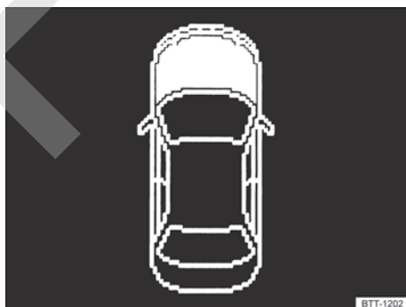
Fig. 141 Representación esquemática en la pantalla del cuadro de instrumentos: capó del motor abierto o no cerrado correctamente.
