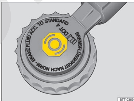
Fig. 111 En el vano motor: tapa del depósito del líquido de frenos.
