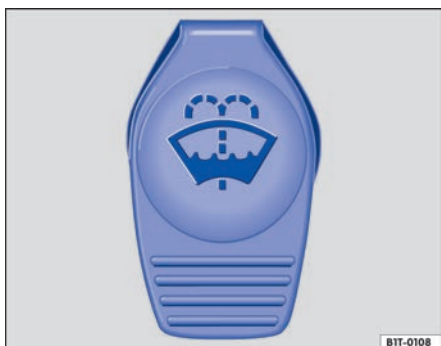
Fig. 76 En el vano motor: tapa del depósito del lavacristales.
