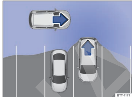
Fig. 132 Representación esquemática del asistente de salida del aparcamiento: zona vigilada alrededor del vehículo que está desaparcando.
