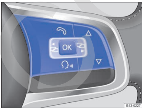
Fig. 15 En el lado derecho del volante multifunción: teclas para utilizar los menús del cuadro de instrumentos.
