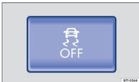
Fig. 109 En la parte inferior de la consola central: tecla para desconectar y conectar manualmente la función ASR o el programa electrónico de estabilización (ESC).
