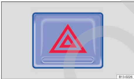
Fig. 162 En la parte superior de la consola central: pulsador de los intermitentes de emergencia.
