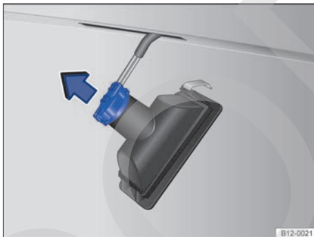
Fig. 142 Luz de la placa de licencia: retirar el portalámparas.
