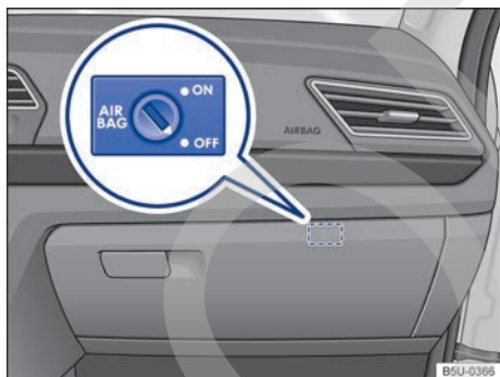
Fig. 18 En la guantera: interruptor desactivado por la llave para desconectar y conectar el airbag frontal del pasajero.
