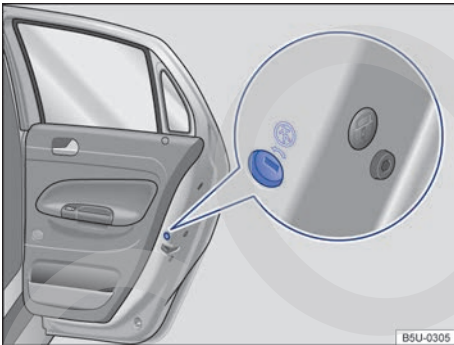
Fig. 24 En la puerta trasera (lado derecho): ubicación del seguro para niños.
