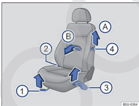
Fig. 70 Comandos del asiento delantero izquierdo.
