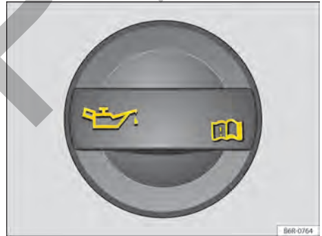
Fig. 148 En el compartimento del motor: tapón de la boca de llenado del aceite del motor.
