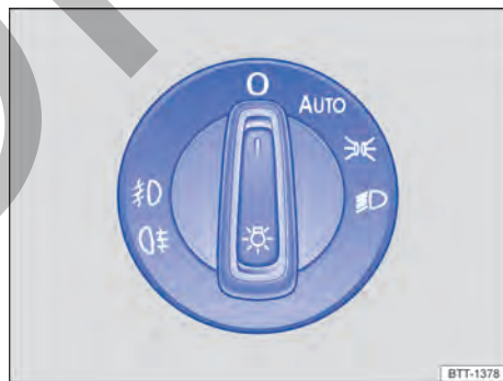
Fig. 71 Al lado del volante: interruptor de luces (una variante).
