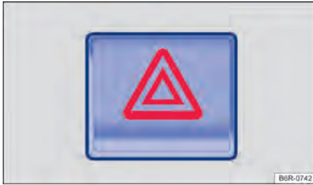
Fig. 44 En la parte superior de la consola central: interruptor de las luces de advertencia.
