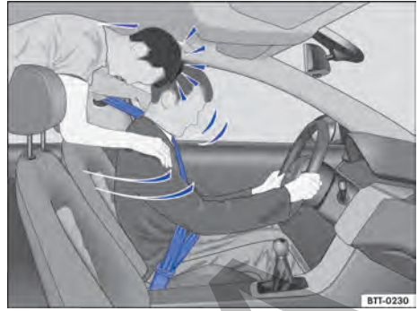
Fig. 24 El pasajero sin cinturón de seguridad en el asiento trasero es lanzado hacia adelante sobre el conductor con cinturón de seguridad.
