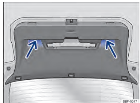
Fig. 57 Tapa trasera abierta: cavidades (flechas) para tirar y cerrar.
