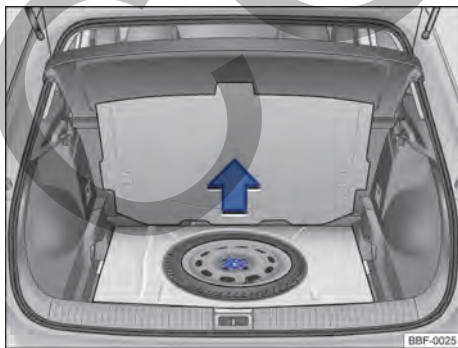
Fig. 122 En el maletero, por debajo del revestimiento del piso: rueda de emergencia y herramientas de a bordo.
