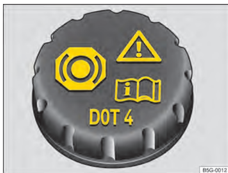
Fig. 151 En el compartimento del motor: tapón de cierre del depósito del líquido de frenos.
