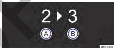
Fig. 85 En el instrumento combinado: indicador de cambio de marcha.
