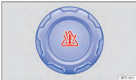
Fig. 150 En el compartimento del motor: tapa del depósito de expansión del líquido refrigerante del motor.
