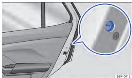
Fig. 53 En la puerta trasera: bloqueo de emergencia.
