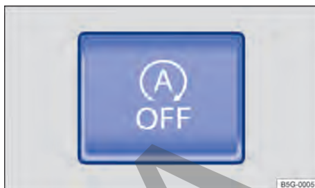
Fig. 105 En la parte inferior de la consola central: tecla del sistema Start-Stop.
