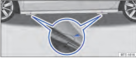
Fig. 206 Puntos de apoyo para el gato.
