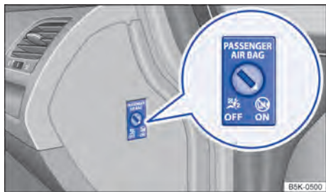
Fig. 41 En el tablero de instrumentos del lado del acompañante: conmutador de llave para activar y desactivar el airbag frontal del acompañante.
