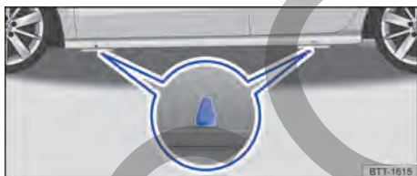
Fig. 204 Puntos de apoyo para el gato.
