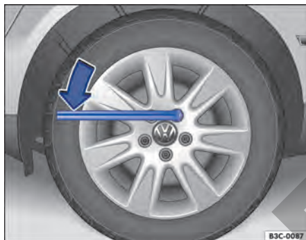
Fig. 202 Cambio de rueda: aflojar los tornillos de rueda.
