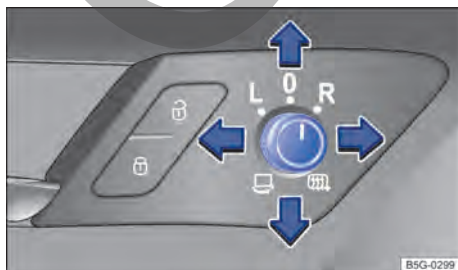
Fig. 93 En la puerta del conductor: mando giratorio de los retrovisores exteriores.
