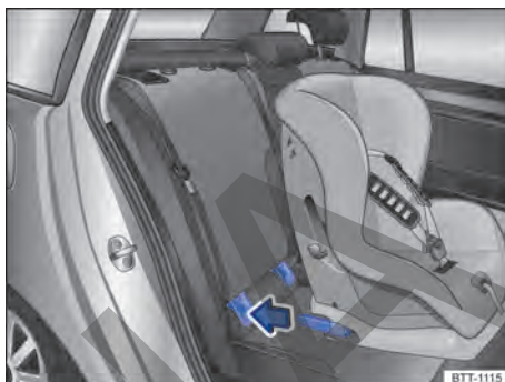
Fig. 50 Representación esquemática: montaje de un asiento para niños ISOFIX con conectores.
