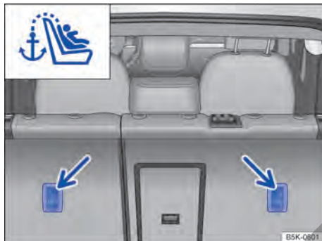
Fig. 51 Argollas de sujeción en la parte posterior del asiento trasero para fijar el cinturón de fijación superior.
