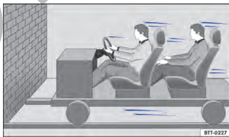
Fig. 28 Vehículo a punto de chocar contra un muro. Los ocupantes no llevan colocado el cinturón de seguridad.
