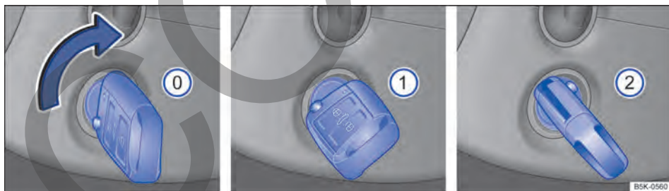
Fig. 102 Junto al volante, en el lado derecho: posiciones de la llave del vehículo en la cerradura de encendido.
