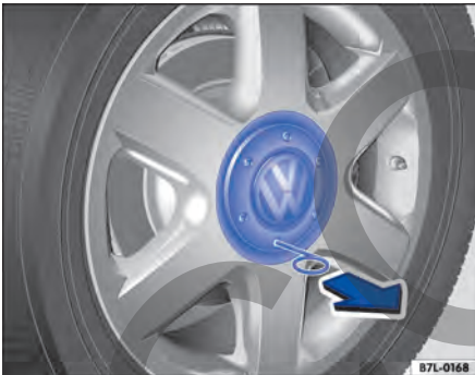
Fig. 198 Desmontar el tapacubos central tirando de él.
