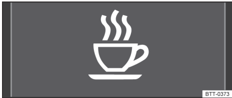
Fig. 13 En la pantalla del cuadro de instrumentos: símbolo de detección del cansancio.
