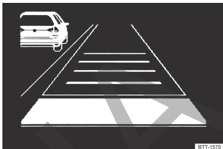
Fig. 116 En la pantalla del cuadro de instrumentos: vehículo detectado que circula más lentamente que el propio por el carril izquierdo (representación esquemática).
