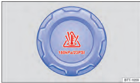
Fig. 187 En el vano motor: tapa del depósito de expansión del líquido refrigerante del motor (representación esquemática).
