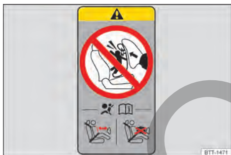
Fig. 48 Etiqueta adhesiva relativa al airbag en el pilar B (representación esquemática).
