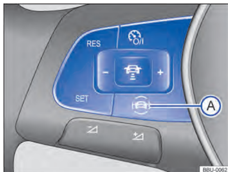
Fig. 20 Lado izquierdo del volante multifunción: tecla de los sistemas de asistencia al conductor...
