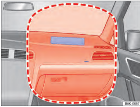
Fig. 40 Ubicación y zona de despliegue del airbag frontal del acompañante.
