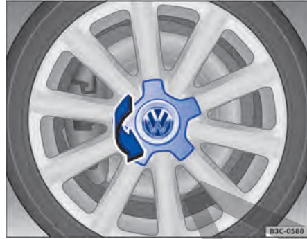
Fig. 199 Desmontar el tapacubos central girándolo.
