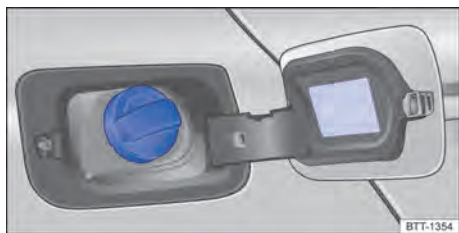
Fig. 156 Tapa del depósito de combustible abierta con el tapón enganchado en ella.
