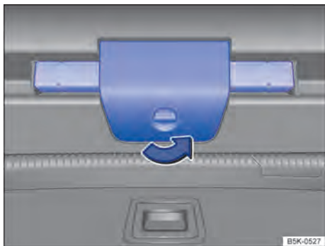
Fig. 66 En el portón del maletero: abrir el soporte del triángulo de preseñalización.
