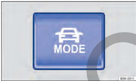
Fig. 113 En la parte inferior de la consola central: tecla de selección del perfil de conducción.
