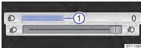
Fig. 86 En el sistema de infotainment: botón desplazable para regular el alcance de las luces.
