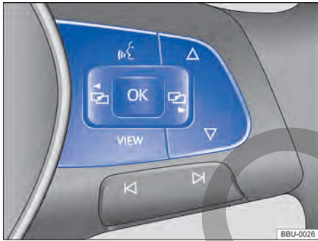
Fig. 19 Lado derecho del volante multifunción: teclas para utilizar los menús y las indicaciones informativas del cuadro de instrumentos.
