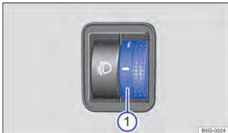
Fig. 85 Junto al volante: regulador del alcance de las luces ①.
