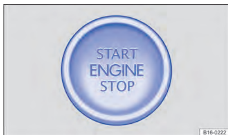
Fig. 103 En la parte inferior de la consola central: pulsador de encendido y arranque para poner el motor en marcha.
